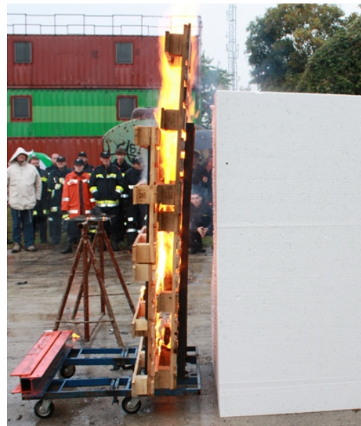
Foto: Égő fa raklapokat helyeztek az EPS tömb elé
