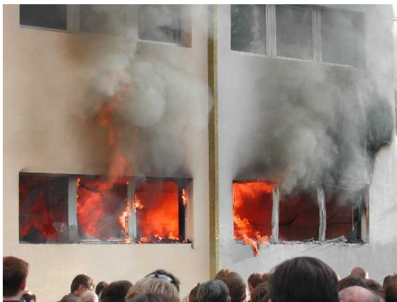
Foto: Homlokzati tűzterjedési vizsgálat 27. perc
